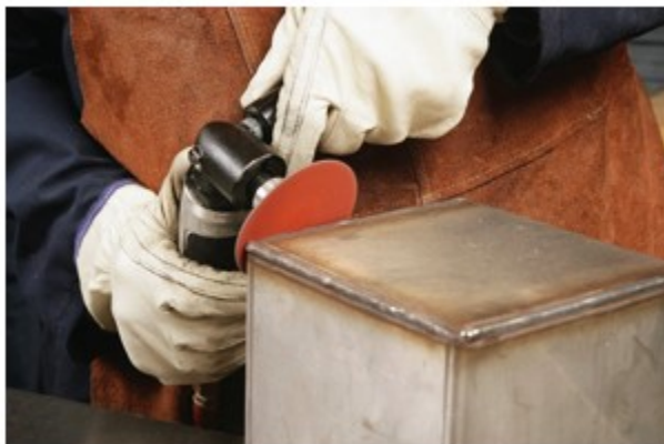
Рис. Зачистка сварного шва после сварки
